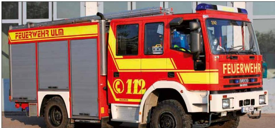
Löschgruppenfahrzeug LF 10/6 mit 1200Liter Tank
