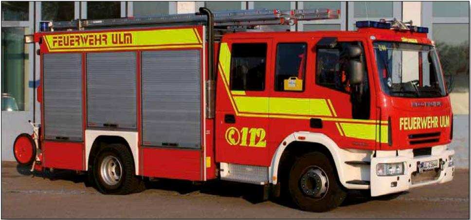
Löschgruppenfahrzeug LF 20/16 mit 2400Liter Tank
